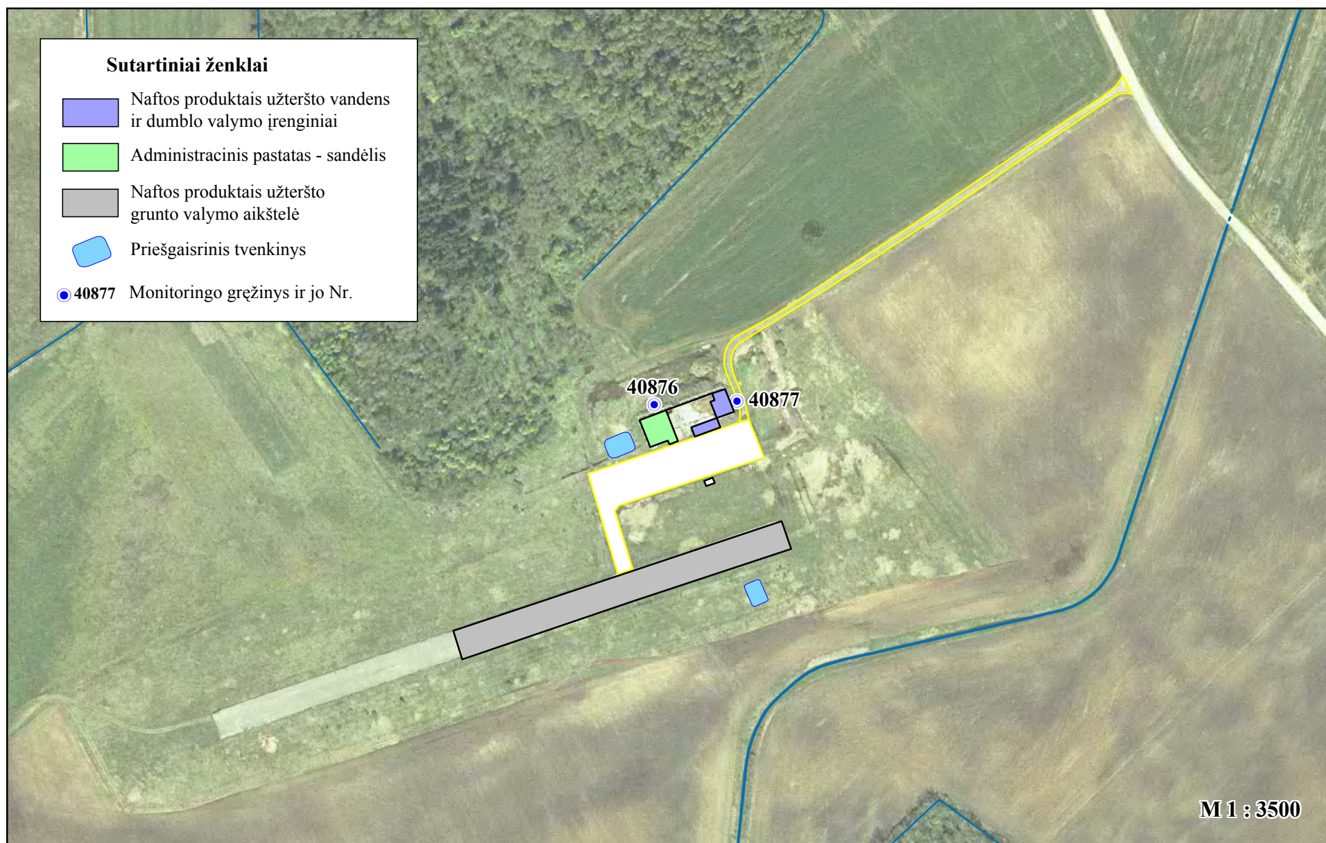
2 pav. Požeminio vandens monitoringo gręžinių išdėstymo schema
